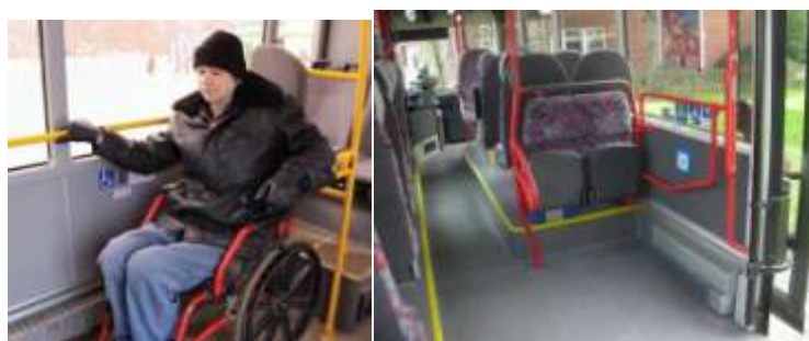
Рисунок 49 – Оборудование подвижного состава для комфортного перемещения МГН
