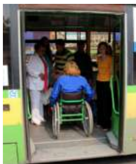
Рисунок 48 – Отсутствие площадки для представителя МГН в подвижном составе
