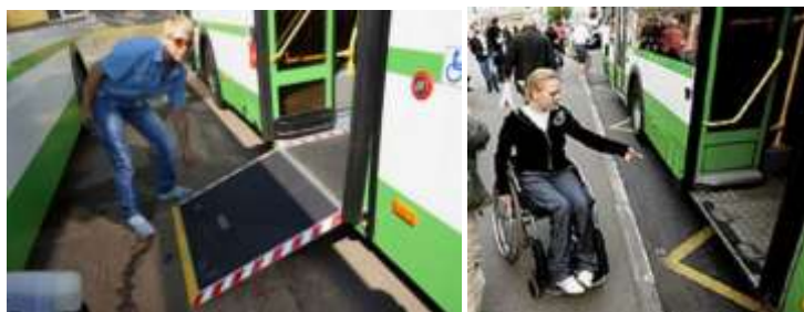
Рисунок 47 – Зазор между транспортным средством и бортовым камнем остановочного пункта
