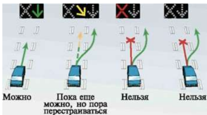
Рисунок 28 – Сигналы дорожных светофоров при реверсивном движении
