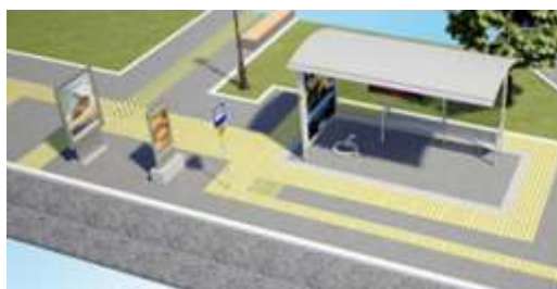
Рисунок 57 – Предложения по расположению тактильной плитки на остановочном пункте
