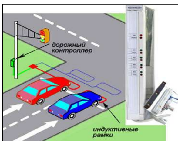
Рисунок 36 – Механизм работы электромагнитного детектора
