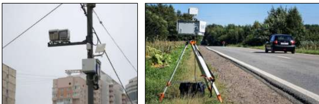
Рисунок 61 – Примеры установки комплексов фотовидеофиксации
