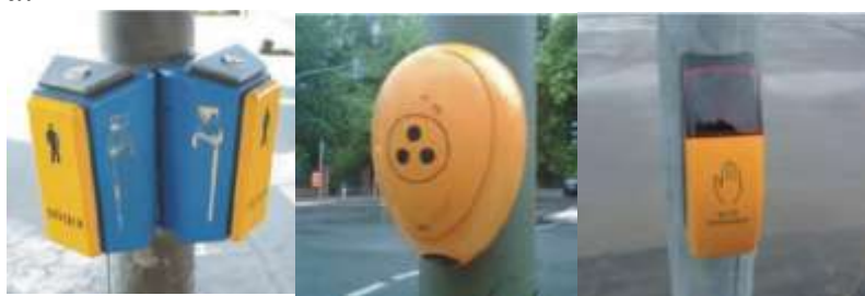
Рисунок 44 – Пример осязательного сигнала пешеходного перехода
