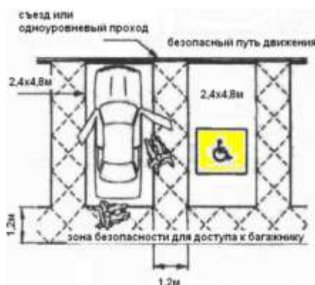
Рисунок 51 – Типовое оборудование парковочного места для МГН перпендикулярно проезжей части
